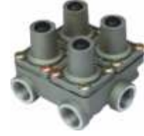
MERCEDES-RENAULT-IVECO-DAF M22*1,5 20 BAR
